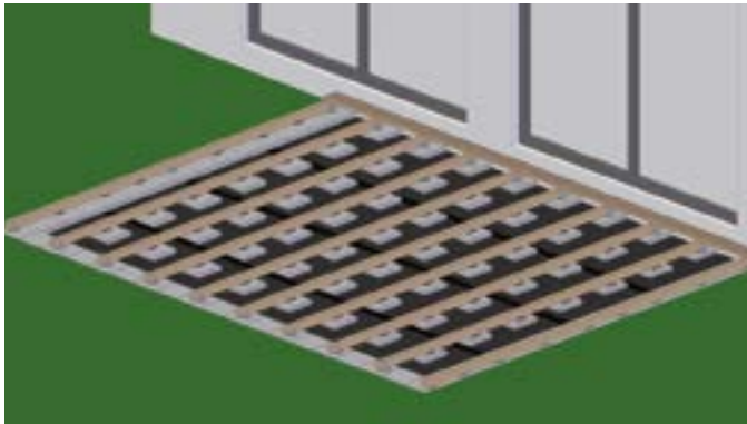
Bei 25 mm starken Terrassendielen sollte der Abstand der Unterkonstruktion max. 50 cm betragen.
