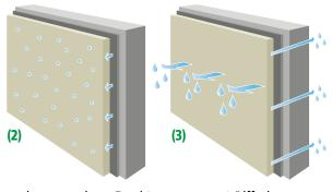
Man spricht in diesem Zusammenhang von einem Feuchtemanagement. Diffusionsoffene, kapillaraktive Innendämm-Systeme sind so eingestellt, dass sie schwankende Feuchtebelastungen abpuffern und nivellieren können. Sie sorgen so für ein angenehmes und ausgeglichenes Raumklima.
