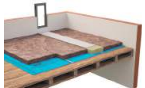
Links die begehbare Dachboden-Dämmplatte TPD-L in Kombination mit Fertigteil-Estrich. Rechts die Dämmrolle Classic mit einem Laufweg aus der druckfesten Materialkombination, wenn Teile des Dachbodens begehrbar sein sollen.
